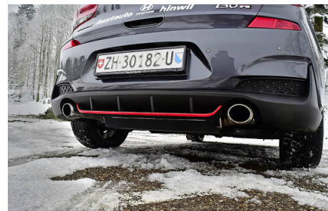
Serienmässige Sportabgasanlage mit variabler Klappensteuerung.
