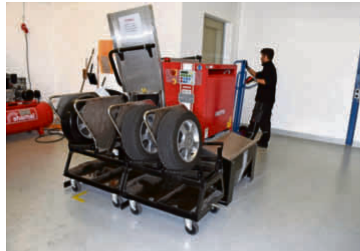
Die neue, vollautomatische Reifenwaschanlage. Im Hintergrund der neue Lift, der das Reifenlager mit der Garage verbindet. (Bilder Gerold Schmid)
